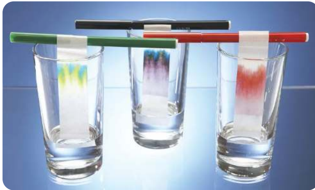
Gambar 5.30 Contoh hasil kromatografi pada tinta warna warna
