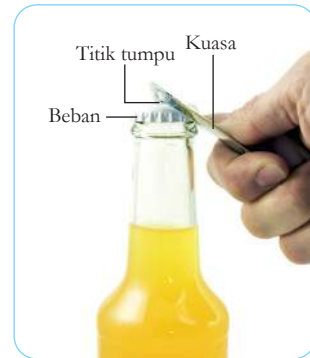
Gambar 3.15 Alat pembuka botol, contoh pengungkit jenis 2
